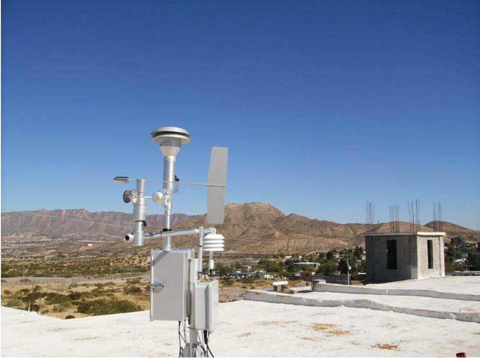
Foto 2. Estación 18, Monitor instalado en la azotea de la Iglesia.
