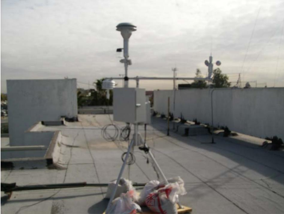
Foto 2. Estación 21, Monitor instalado en la Azotea de la Central de Bomberos
